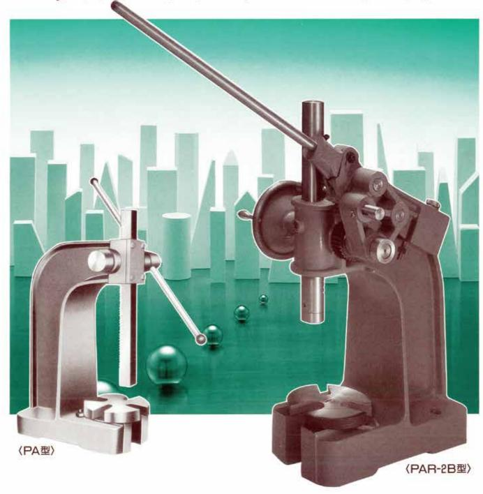
アーバブレスは手動力によって作業する簡易ブレスです。たとえば、ポンプのランナのそう入、ブッシュの打込み、ベアリングのはめ込み、ノックピンの抜き取り、棒材のひずみ取りなどの作業では、加工物を傷つけることなく安全・容易に作業することができます。カッタアーバを抜くとき使用されるのでアーバブレスといわれています。
