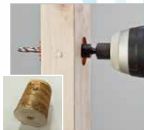
鉄釘の入った 2×4 材も一発貫通 (スプリングを取り外して加工)
